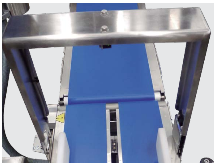
> Detector vertical en pórtico
