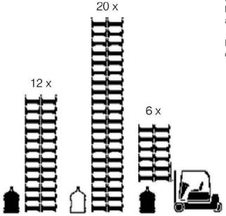
Les racks modulables permettent leur rangement en colonne de 12 avec des bonbonnes pleines et jusqu'à 20 avec des bonbonnes vides.
