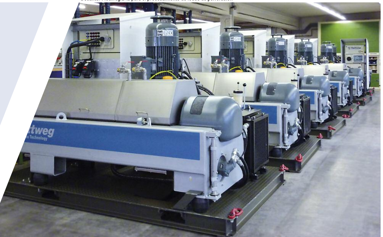
Decanter Flottweg Z4E para el procesamiento de lodos de perforación
