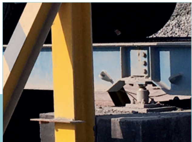
La célula de carga PR 6221 de la báscula para vehículos garantiza unos resultados de medición precisos, una larga vida útil del producto y una fiabilidad excepcional
